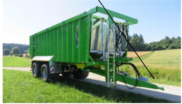
Hydraulisch betätigtes Klappdach mit Netz (Aufpreis)
