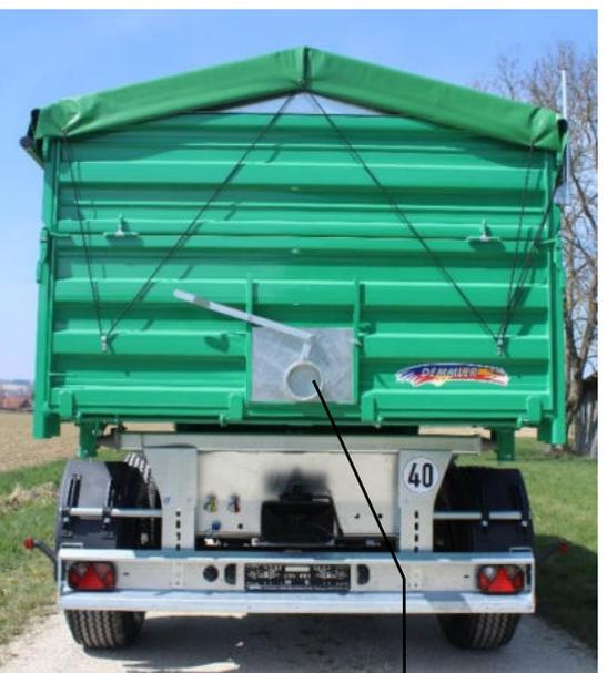
Kornschieber (Serie), Auslaufrühr (Aufpreis) Stabiler Unterfahrerschutz (Serie)
