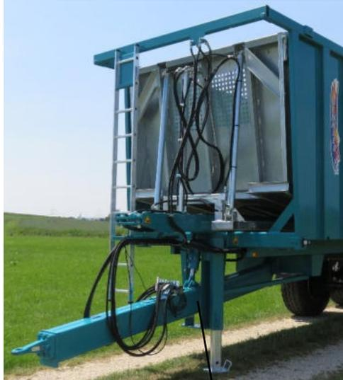
Hydr. gefederte Deichsel für Untenanhängung, mech. Stützfuß (TSM Serie)
