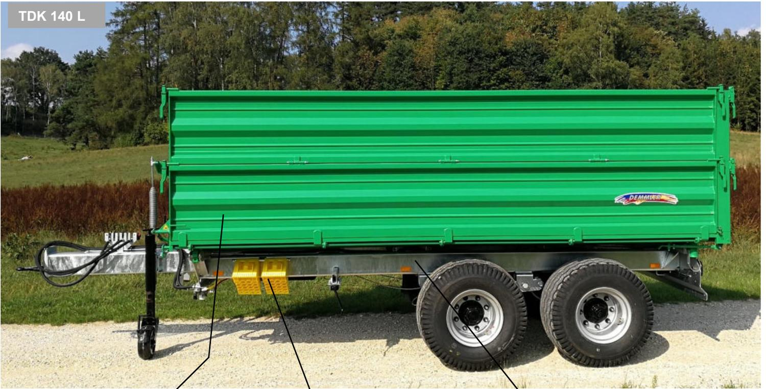
Stahlbordwände mit Zentralverriegelung (Serie)
