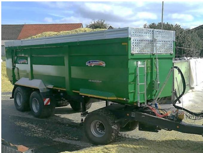
Großer Kippwinkel dank 6-Stufen-Kippzylinder
