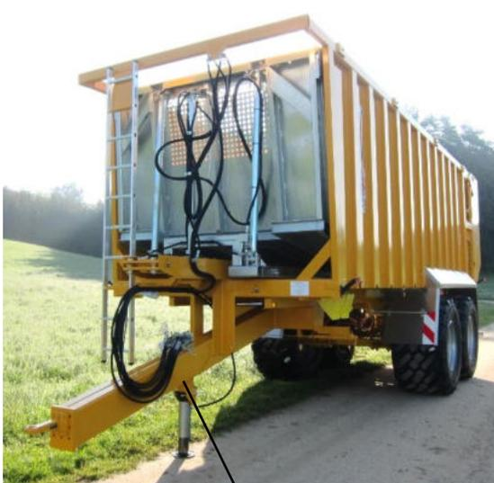
Starre Deichsel für Untenanhängung, hydraulischer Stützfuß (TSM Light Serie)
