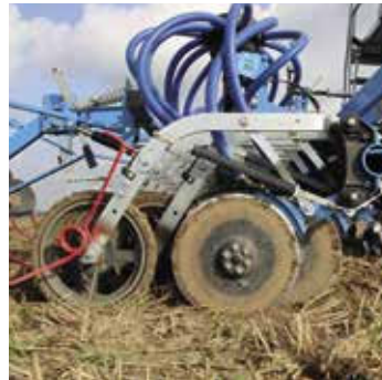
Das OptiDisc Doppelscheibenschar mechanisch bis 45 kg Schardruck
