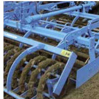
Hydraulische Planierschienen- verstellung
