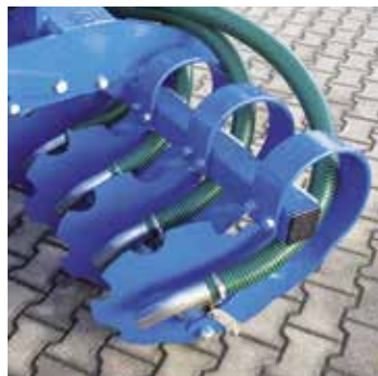
Injektion des Düngers hinter der ersten Scheibenreihe
