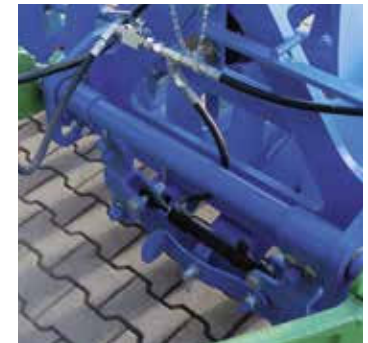
Hydraulische Vorspannung der Lenkung
