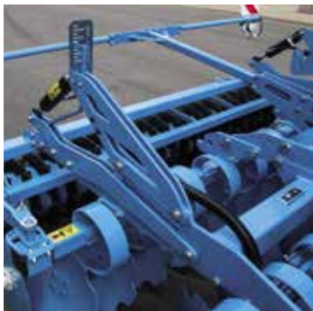
Hydraulische Arbeitstiefen- verstellung
