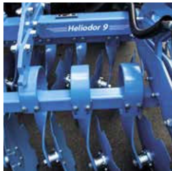
Scheiben im Bereich der Traktorspur separat einstellbar
