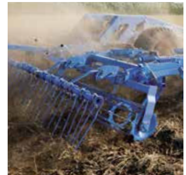
Nachlaufende Kombination aus Walze und Striegel
