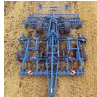
Symmetrisch zur Zugachse angeordnete Zinken
