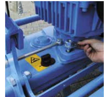
Drehrichtungswechsel für unterschiedliche Einsatzbedingungen
