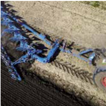
Großer Freiraum zwischen Pflugturm und Drehwerk
