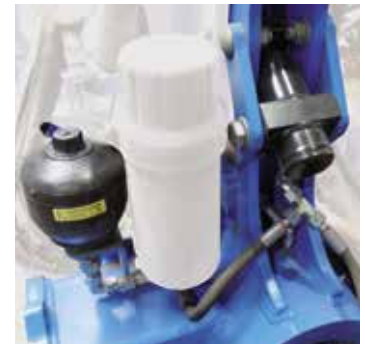
Dämpfungszylinder im Pflugarm
