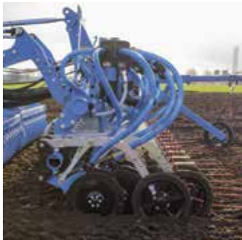
Verteiler über der Säschiene
