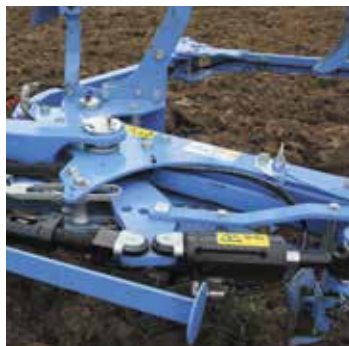
Hydraulische Arbeitsbreiten- verstellung
