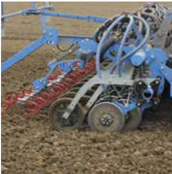
Das OptiDisc Doppelscheibenschar hydraulisch bis 70 kg Schardruck
