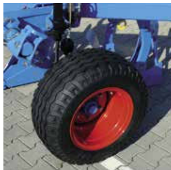
Hydraulische Arbeitstiefen- verstellung
