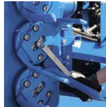
Messerzinken mit Schnellwechselsystem
