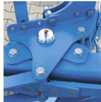
Hydraulisch einstellbare Arbeitsbreite (nur Titan 18 V)
