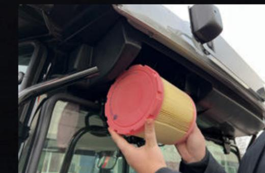
Gut zugänglicher Kabinenluftfilter, einfach zu entnehmen und zu reinigen; der Schmutz bleibt draußen.
