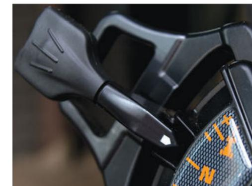
Der exklusive **PowerControl**-Hebel ermöglicht die bequeme und einfache Bedienung von drei Funktionen. Der Fahrer kann die Fahrtrichtung wechseln (Vorwärts/Rückwärts) oder den Leerlauf anwählen und dabei die rechte Hand zur Bedienung des Heckkrafthebers oder Hydraulikgeräts frei behalten.
