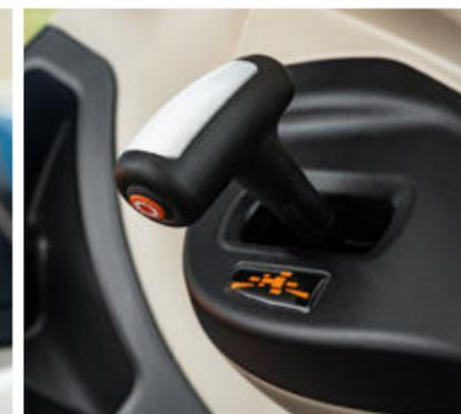
Tippen Sie den **T-förmigen Fahrhebel** einfach nach vorn oder zurück, um die vier Dynashift-Lastschaltstufen hoch bzw. runter zu schalten. Zum Wechsel der Gruppen betätigen Sie zusätzlich während des Schaltens den Druckknopf im Schaltknäuf.
