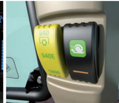
Die **zusätzlichen Kriechgänge** ermöglichen bei Arbeiten, die besonders langsame Geschwindigkeiten erfordern, eine präzise Regelung der Vorwärtsgeschwindigkeit bis zur niedrigen Geschwindigkeit von 100 m/h.
