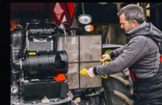
Die Kühleinheit ist leicht zu erreichen und lässt sich dadurch bequemer und schneller reinigen.
