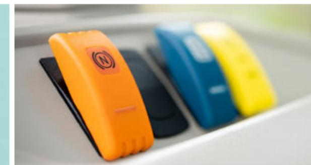
Durch Aktivieren der Funktion **Bremse auf Neutral** wird parallel automatisch die Kupplung getrennt, sobald das Bremspedal betätigt wird.
