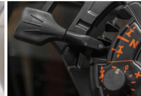
Das **PowerShuttle** ermöglicht den Wechsel der Fahrtrichtung ganz ohne Bedienung des Kupplungspedals.
