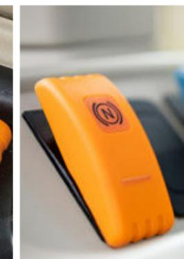
**Bremse auf Neutral** ermöglicht optional die parallele Bedienung der Kupplung, wenn das Bremspedal betätigt wird. Dies vereinfacht erheblich die Arbeit des Fahrers, während gleichzeitig Effizienz und Komfort gesteigert werden. Diese Funktion ist besonders hilfreich bei Frontladerarbeiten und am Vorgewende.
