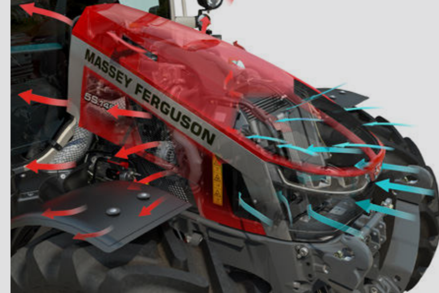
Ein neues, optimiertes Luftführungssystem verbessert die Motorkühlung und steigert sowohl Leistungsfähigkeit als auch Effizienz. Dank des neuen Designs der Belüftungsschlitze werden alle Kühler maximal und effizient mit Frischluft durchströmt.
