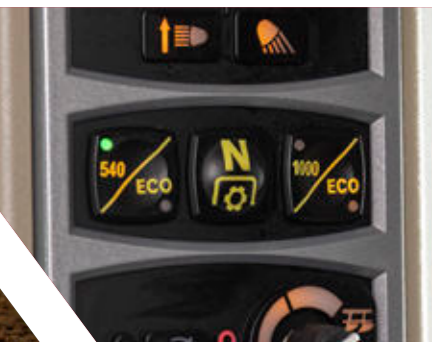
Elektrohydraulisch vorgewählte Zapfwelldrehzahl
