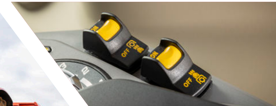
Elektrohydraulisch vorgewählte Zapfwelldrehzahl
