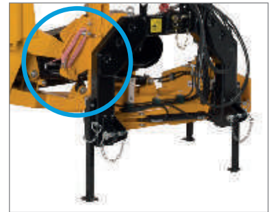
Automatisch verriegelnde, mechanische Transportsicherung, für eine schnelle Abfahrbereitschaft.
