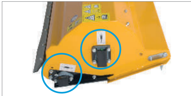
Gut zugängliche Lagerstellen für eine schnelle Wartung.
