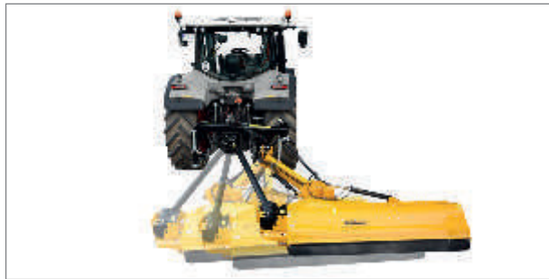
Ein großzügiger Schwenkbereich ermöglicht das Arbeiten sowohl hinter als auch neben dem Traktor. Enge Zufahrten und Seitenstreifen können gleichermaßen gemulcht werden.
