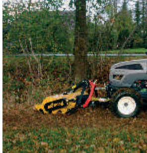
Der MU-C für den Frontanbau: Niedrige Koppelpunkte und ein tief liegendes Getriebe (Eingangsdrehzahl von 1.000 oder 2.000 U/min).
