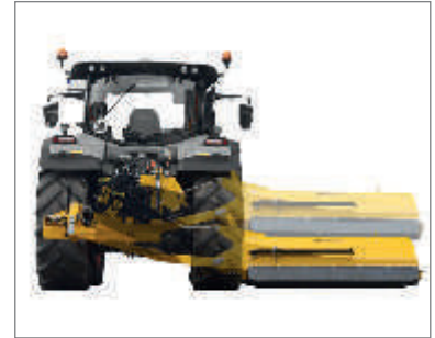
Die Höhe des Mulchgerätes lässt sich hydraulisch einstellen. Damit können auch Plateaus neben dem Traktor gemulcht werden.
