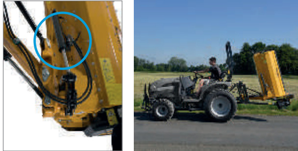
Sichere Transportverriegelung bei Straßenfahrt oder beim Transport des Gespanns mit dem PKW-Anhänger.
