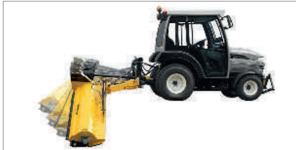
Mechanische, patentierte Anfahrtsicherung löst zuverlässig aus und kehrt selbständig in Arbeitsposition zurück.
