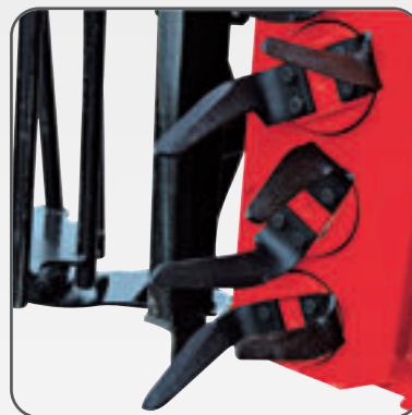
Protezione parasassi totale VX-VZ-DB Total stone protection VX-VZ-DB Totaler Steinschutz VX-VZ-DB Protection anti-pièrres totale VX-VZ-DB
