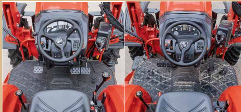
Die Unterschiede sind durch die Pedale erkennbar. Während der Schalter mit Kupplung und Gaspedal arbeitet...
